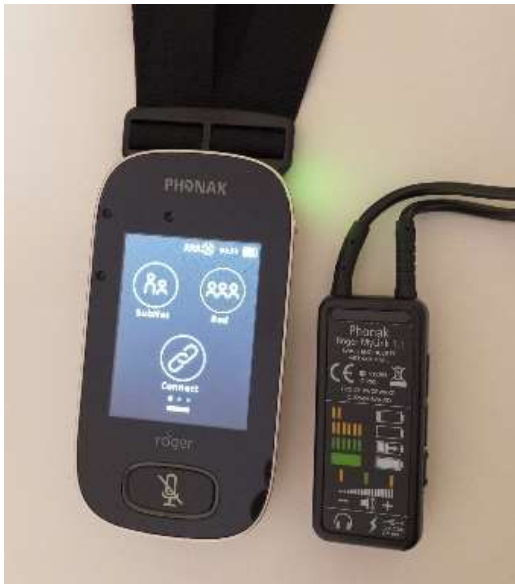
Sistema de Micrófono Remoto. Fuente: FASPAS CLM.
